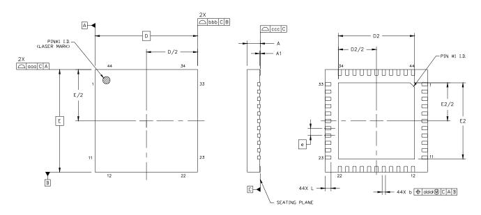
Figure 20. 44-Pin Quad Flat No-Lead (QFN)
