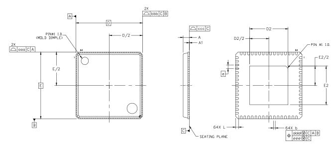
Figure 19. 64-Pin Quad Flat No-Lead (QFN)
