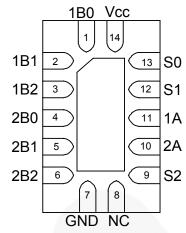
Figure 3. DQFN-14 (Top Through View)
