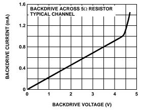
FIGURE 23. BACKDRIVE VOLTAGE vs CURRENT
