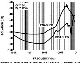
FIGURE 6. INPUT TO OUTPUT ISOLATION vs FREQUENCY
