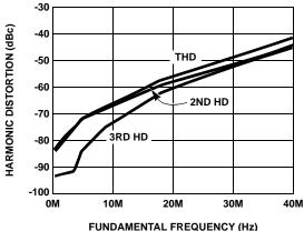
FIGURE 13. HARMONIC DISTORTION vs FREQUENCY
