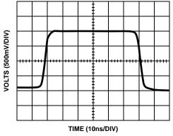
FIGURE 20. LARGE SIGNAL RISE AND FALL TIMES
